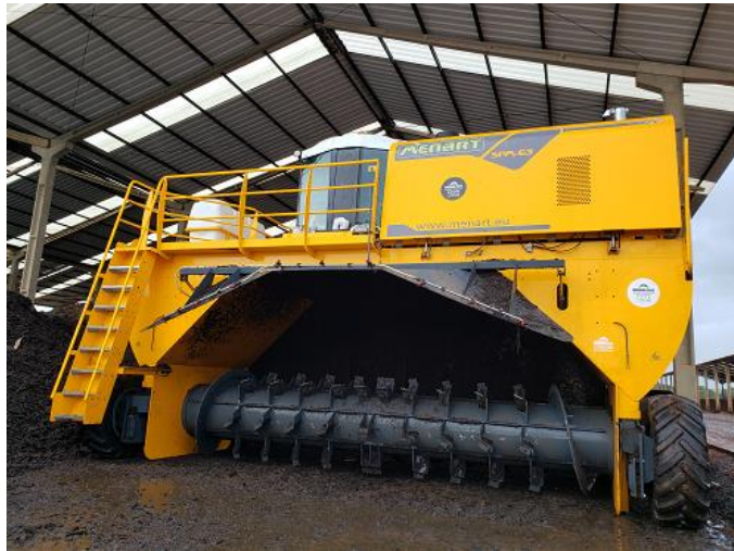
Figura 21 - Modelo de máquina rural com medicações de segurança implantadas – revolvedora de composto orgânico.
